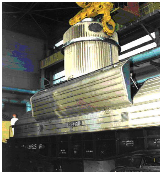
Выгрузка транспортного контейнера с ОЯТ из спецвагона на ПО «Маяк», г. Озерск, Челябинской области
